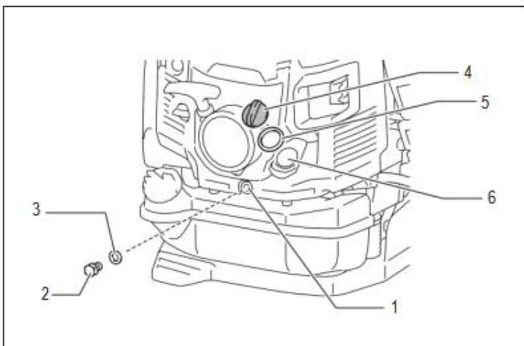
1. Orifice de vidange 2. Écrou 3. Joint (rondelle en fer) 4. Bouchon 5. Joint du bouchon 6. Port d'huile
