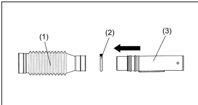
► (1). Tuyau flexible (2). Collier de serrage (3). Tuyau pivotant.
