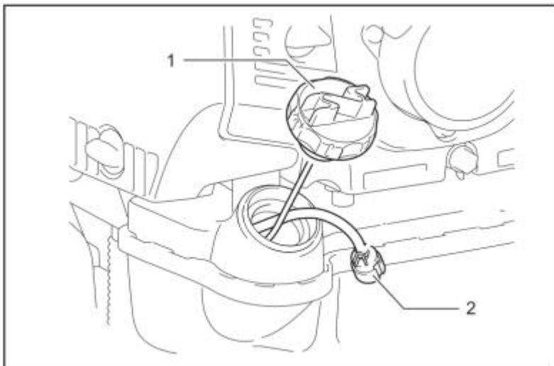
► 1. Bouchon du réservoir 2. Filtre de carburant
