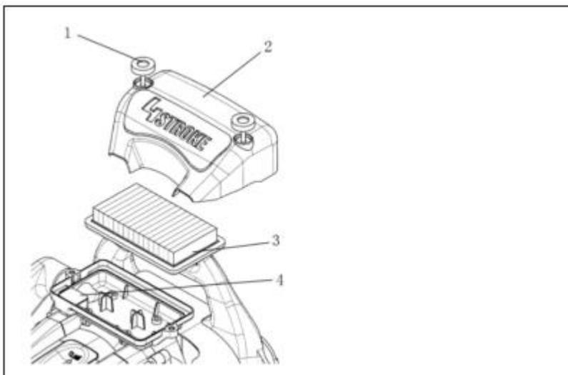
► 1. Boulons 2. Couvercle du filtre à air 3. Filtre 4. Reniflard
